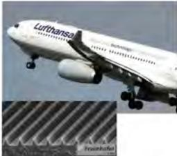
オーストラリア航空、コロンビア航空の機体、エアバス社の共同研究によるサメ肌構造模倣の機体塗装
